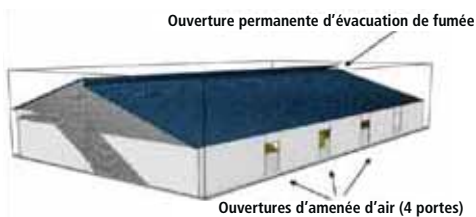
Figure 10 : Bâtiment disposant d'ouvertures naturelles à la faîtière
