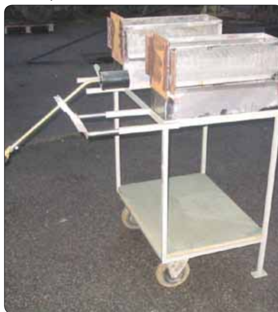
Photo n°3 : Double auge montée en parallèle (FERTILWEST)
