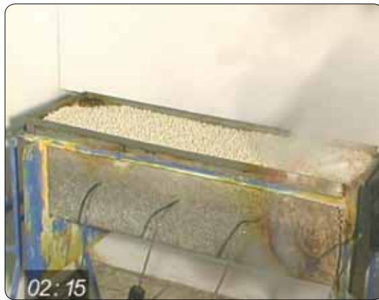
Photo n°5 : Gouttière en toile métallique équipée de thermocouples
